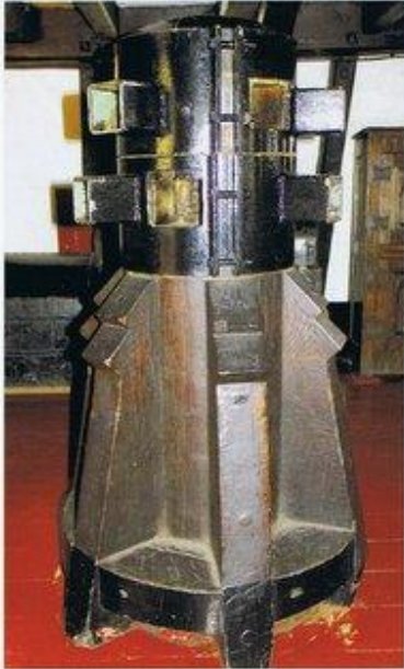
Met de grote kaapstander konden de ankers worden gelicht.
